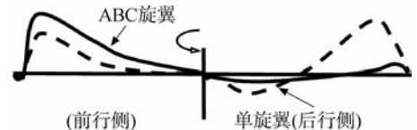
图 1 普通单旋翼与 ABC 旋翼的升力分布对比
